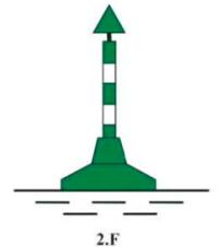
Le cas échéant, ces balises sont équipées d'un feu rythmé et en général d'un réflecteur radar.
